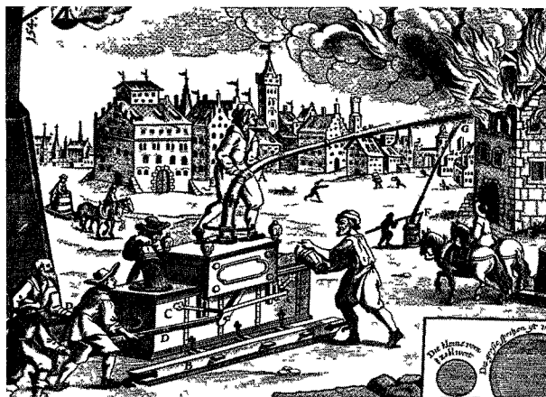
7. Die Feuerspritze von Hautsch nach der Abbildung in Böcklers Theatrum machinarum (1661). – Nach: Stadtbibliothek Nürnberg, Kupferstich Norica 2051.
