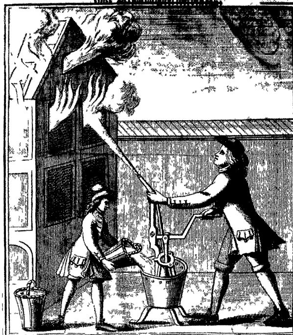
4. Tragbare Feuerspritze System Leupold von 1720. – Nach: J. T. Boetius, Neue Nachricht etc. (Leipzig 1720).
